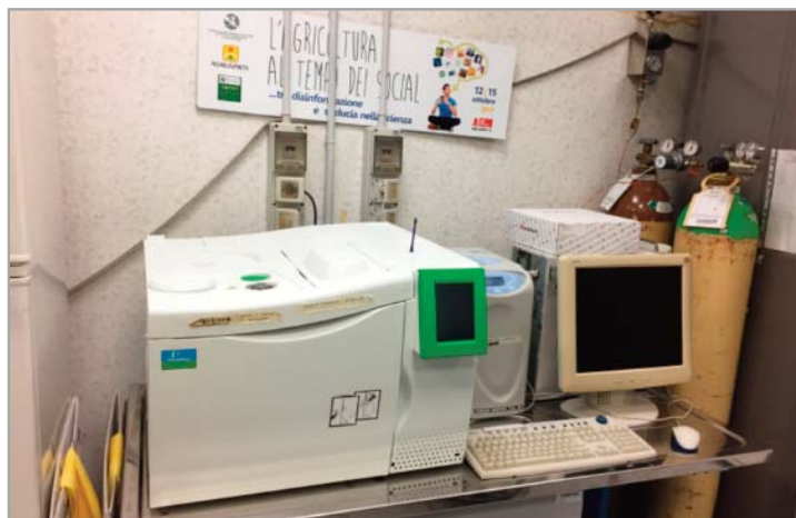
Gas-cromatografo utilizzato per quantificare l'attività azoto fissatrice dei noduli
