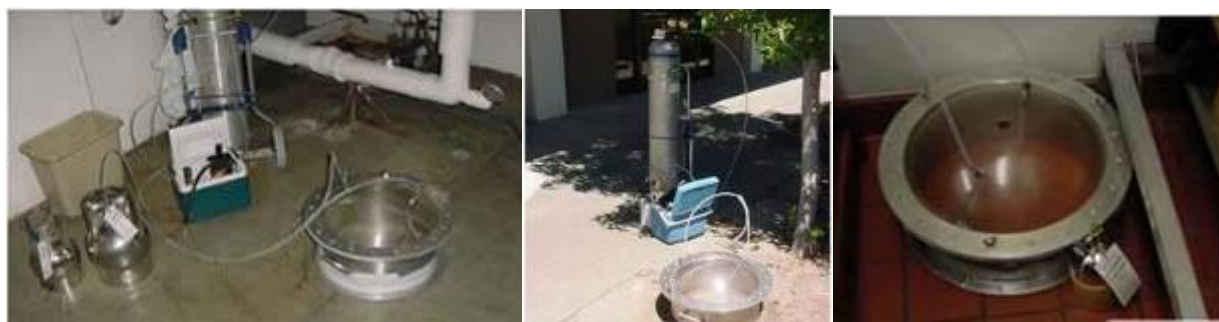
Figura 11 – Esempi di uso camere di flusso in ambiente indoor in USA (fonte: Schmidt, 2017)
