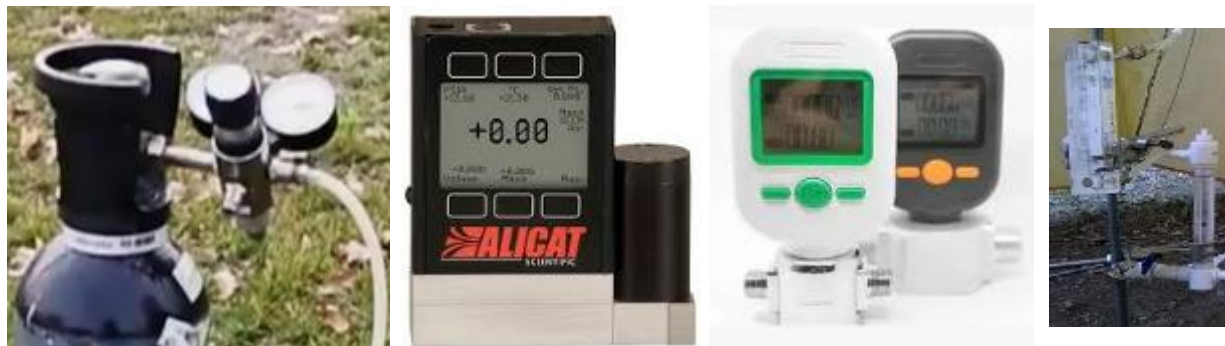
Figura 10 – Sistemi di regolazione e controllo del gas vettore tramite manometro bistadio, mass flow controller, flussimetro digitale o flussimetro meccanico a sfera
