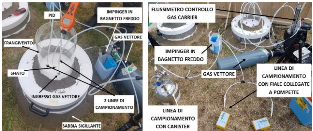
Figura 8 – Esempi dei dispositivi collegati ad una camera di flusso dinamica stazionaria
