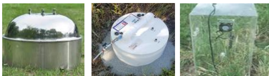
Figura 3 – Esempi di campionamento con le camere statiche chiuse
