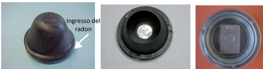
L'ingresso dei prodotti di decadimento del radon (nella loro forma *attached* e *unattached*) e del toron all'interno del dispositivo è impedito grazie alla sua particolare geometria (*l'air gap*, vedi immagini seguenti).
