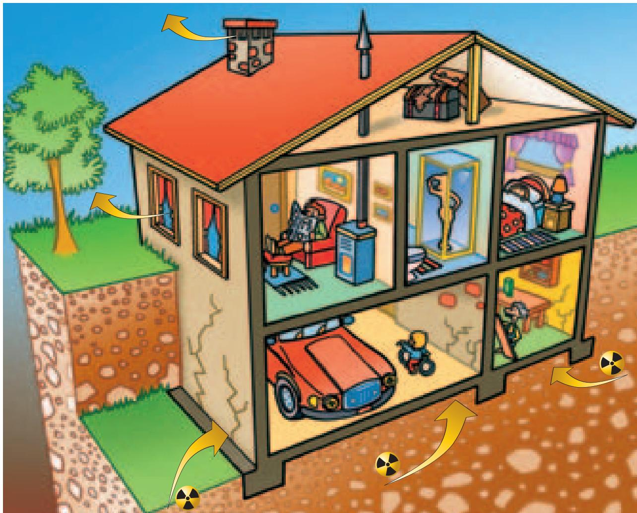
Figura 3.1. Vie di ingresso e di uscita del radon in una abitazione.
