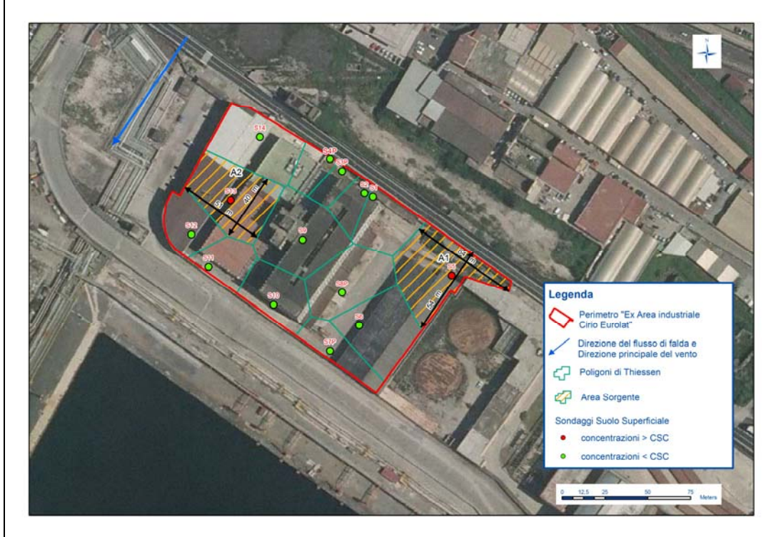
Fig. n. 7 – Dimensioni delle sorgenti nel suolo superficiale e profondo rispetto alla direzione del flusso di falda e del vento
