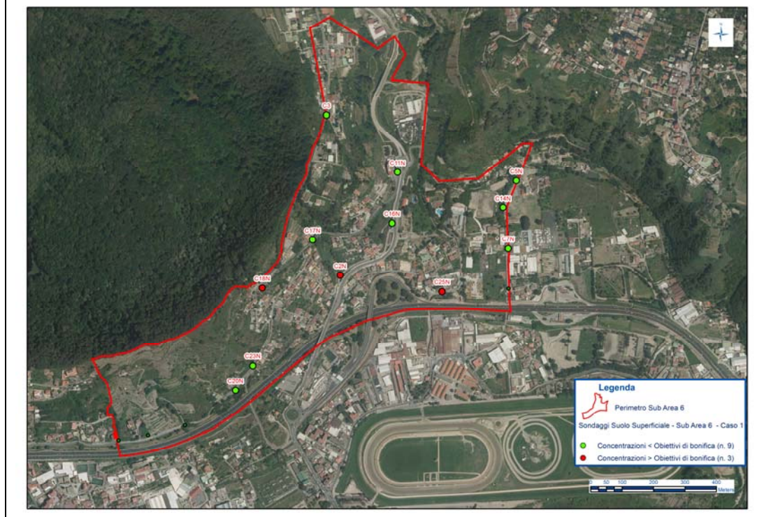
Fig. n. 72 – Rappresentazione Concentrazioni - Obiettivi di Bonifica SS - Sub area 6_Caso 1
