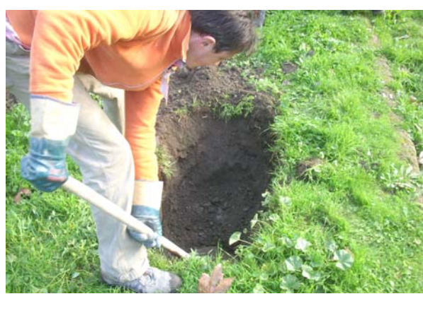
Preparazione del punto di prelievo tramite pulizia dell'area nell'intorno del punto prescelto
